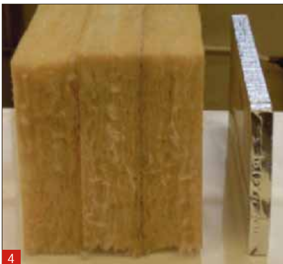
4 De diktereductie die met een vacuïsolatiepaneel kan worden verkregen is een van de meest interessante aspecten voor groot-schalige toepassing in de bouw
